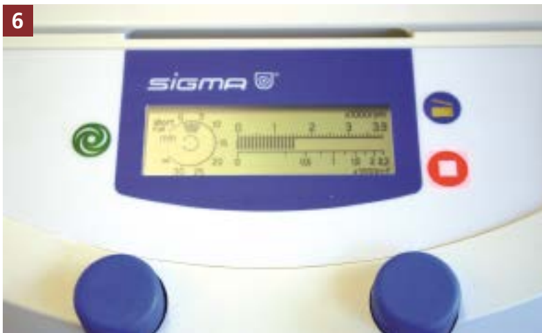
Zentrifugieren des Röhrchens für 3-5 Minuten bei 300 x g (entspricht je nach Zentrifuge etwa 1000 - 1500 U/min).
